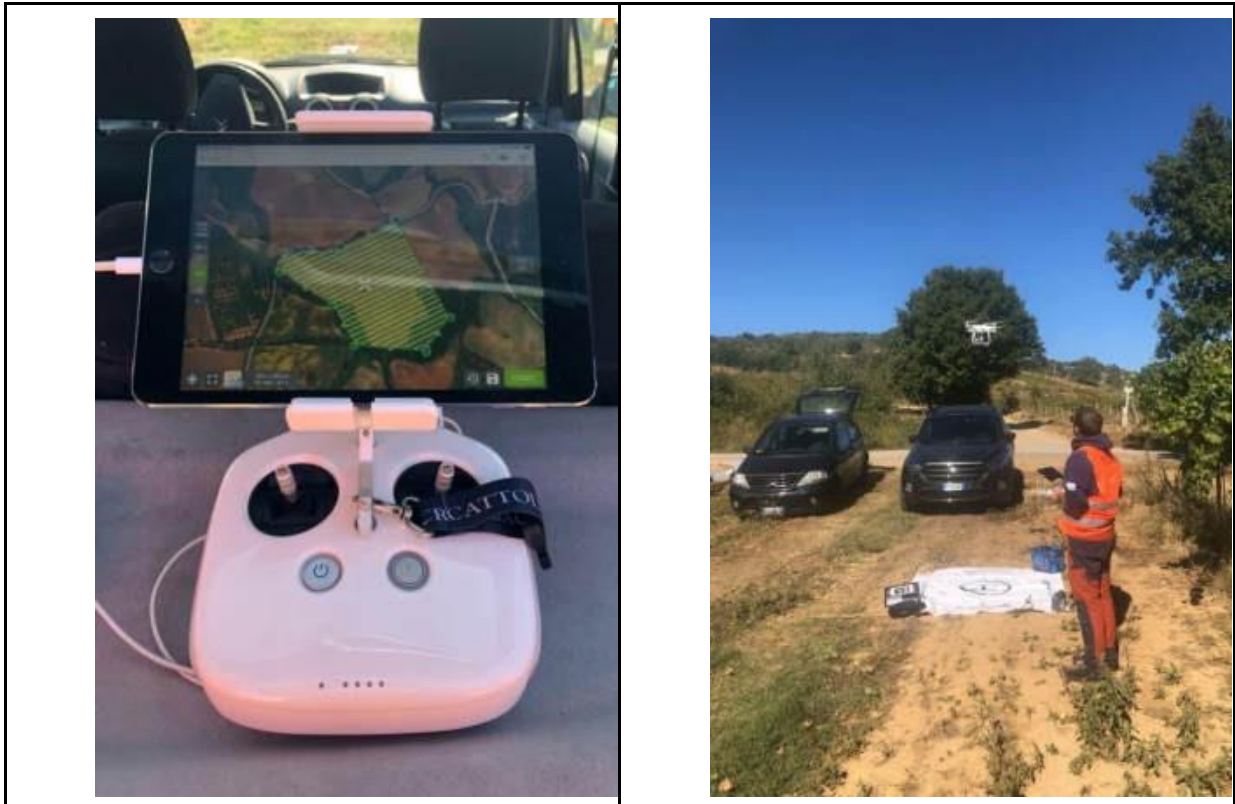
Figura 18 A sinistra: consolle di controllo con piano di volo del drone. A destra Foto dell'operatore mentre fa alzare in volo il drone per le riprese.
